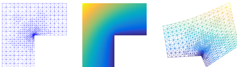
Función armónica en un dominio en forma de L. Malla adaptativa (izquierda) y una aproximación con elementos finitos (centro y derecha) con 1522 grados de libertad.
